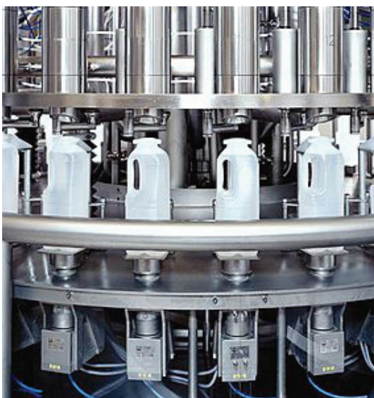
links: Rundläufer-Abfüllanlage (Beispiel aus der Pharmaindustrie mit der grösstmöglichen Abfüllmenge von 500 ml)
